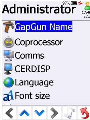
GapGun должен быть установлен на режим совместной обработки в меню Администратора. На ПК должно работать ПО SPC3D в списке серверов. Теперь GapGun будет искать этот сопроцессор.
