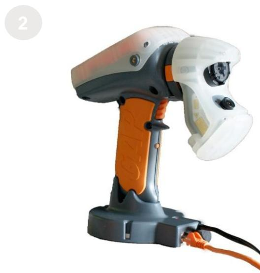
В данном руководстве показано, как использовать Checkplan (План проверки) для проверки точности GapGun с помощью калибровочного измерительного блока или концевого калибра.
