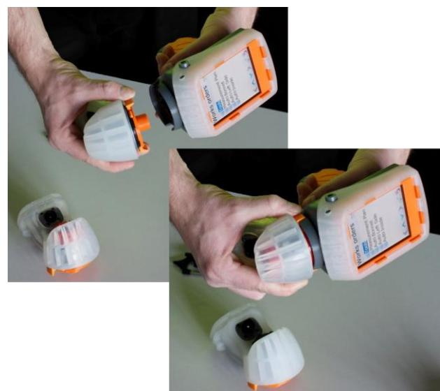
Чтобы заменить головку датчика необходимо нажать на оранжевые фиксаторы Vchange и снять датчик с рукоятки. Затем установить новый датчик на место до щелчка фиксатора. Датчик может быть заменен без выключения GapGun.
