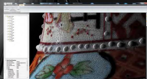
Результат 3D-сканирования: облако цветных точек с разрешением 700 точек/мм 2
