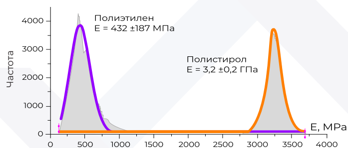
Карта распределения модуля упругости, измеренная на тонкой плёнке смеси полистирола с полиэтиленом.
